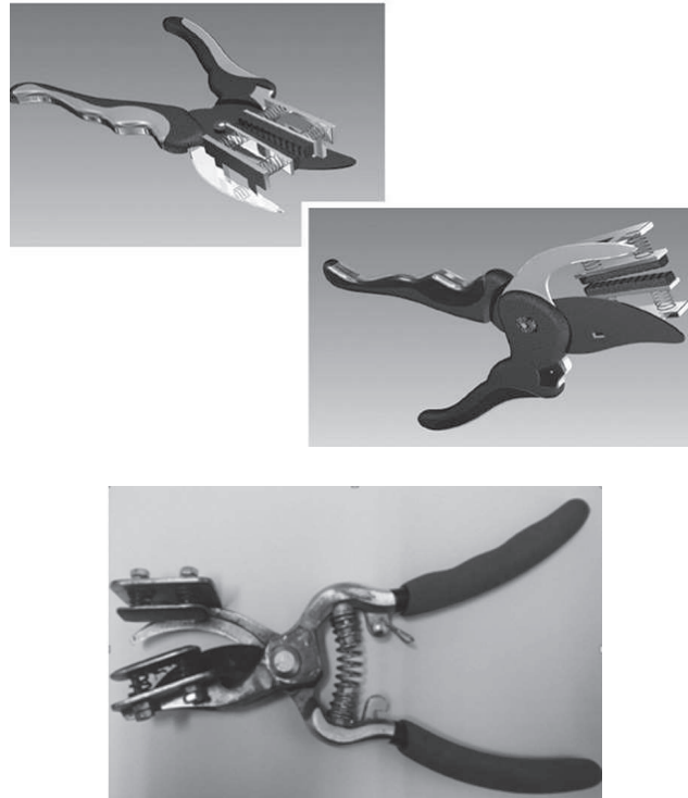
Figura 14. Vista isométrica virtual y real de una herramienta de recolección romero y menta.
